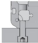
Robot 하부에 일정 간격으로(Catalog 참조) Tap이 가공되어 있으므로 설치면 하부에서 Robot Base 의 하부 쪽으로 Bolt를 체결하도록 되어 있습니다.
