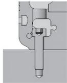
Robot 내부에 일정 간격으로(Catalog 참조) C-Bore 가공이 되어 있으므로 Robot Cover를 탈착한 후 설치면 쪽으로 Bolt를 체결하도록 되어 있습니다. (PERS 60, 80, 120, 160, 200 Model 적용)
