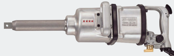
GT-S55R - Bolt dia 52 mm - SQ 25.4 mm - 343-2,450 N·m - 2,800 รอบ/นาที - ระบบคั่นเดี่ยว
